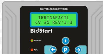
Em seguida, o controlador vai para a tela de standby, onde a mesma pode estar no modo manual ou automático, para mudar entre elas basta pressionar a tecla
