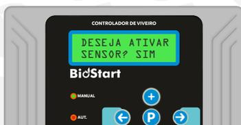
Com o sensor ativado, pode-se definir a pressão máxima e mínima de monitoramento do sensor. Para parametrizar, basta pressionar o botão **→** que irá direcionar o usuário para as telas abaixo:
