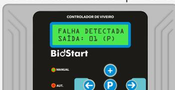
Os motivos que podem levar ao surgimento dessa falha são curto-circuito na solenoide, curto-circuito nos cabos da solenoide ou da válvula elétrica ou até mesmo solenoides com passagem excessiva de corrente elétrica.
