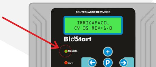
Para alterar os parâmetros do controlador, pressione a tecla **P** para abrir o menu principal. Com as teclas **←** e **→** altera-se a visualização dos parâmetros, e quando for necessário entrar no parâmetro que se deseja, use a tecla **P**. Se nada for pressionado por 10 segundos o controlador retorna para tela de standby.
