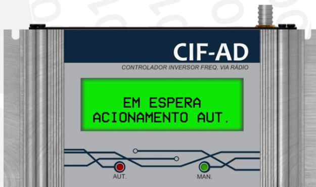
Se o contato NF estiver habilitado, vai iniciar a contagem do tempo para leitura da entrada D1, caso essa entrada não seja fechada é gerada uma falha por contato NF.
