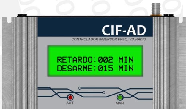
Ao selecionar o parâmetro 03, o módulo transmissor realiza um teste de sinal com o módulo receptor. Se o valor medido for menor que 30 dBm o sinal é excelente, se o valor medido for igual ou maior que 120 dBm o sinal é fraco.
