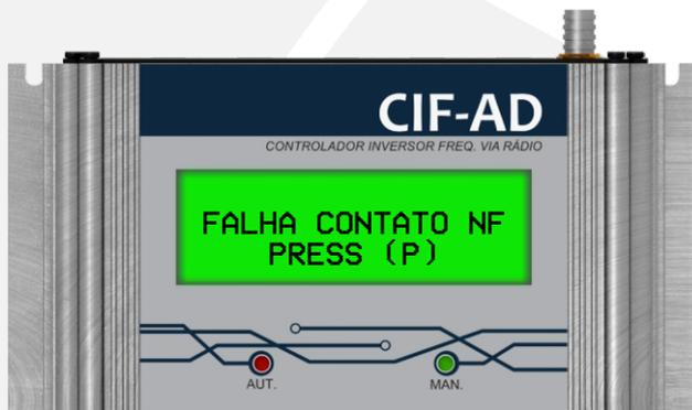
Se durante a operação automático a conexão de sinal for perdida entre os módulos transmissor e receptor, vai apresentar no display uma mensagem de falha até o sinal dos rádios se comuniquem novamente.
