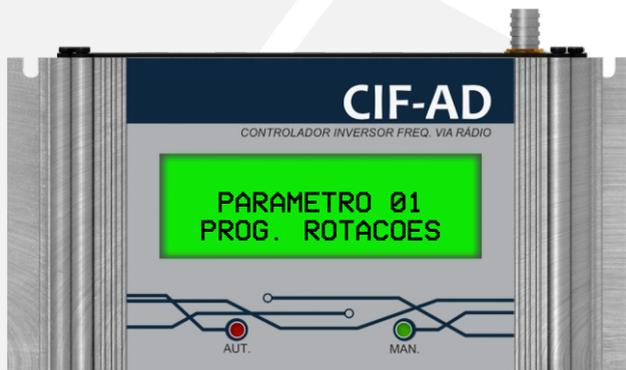
Ao selecionar o parâmetro 01, o módulo transmissor mostra em seu display o setor 01 e a rotação programada. Com as teclas **←** e **→** é possível alterar qual setor está selecionada. Com as teclas **+** e **-** é possível alterar a porcentagem de rotação de cada setor. Com a tecla **P** Pressionada o valor de rotação é salvo para aquele setor.
